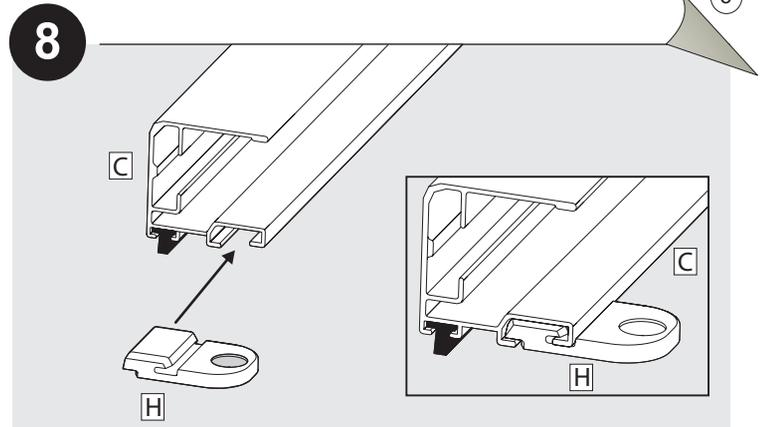
Zwei Stück Wandbefestigungen **H** in jedes Führungsprofil **C** einsetzen.
