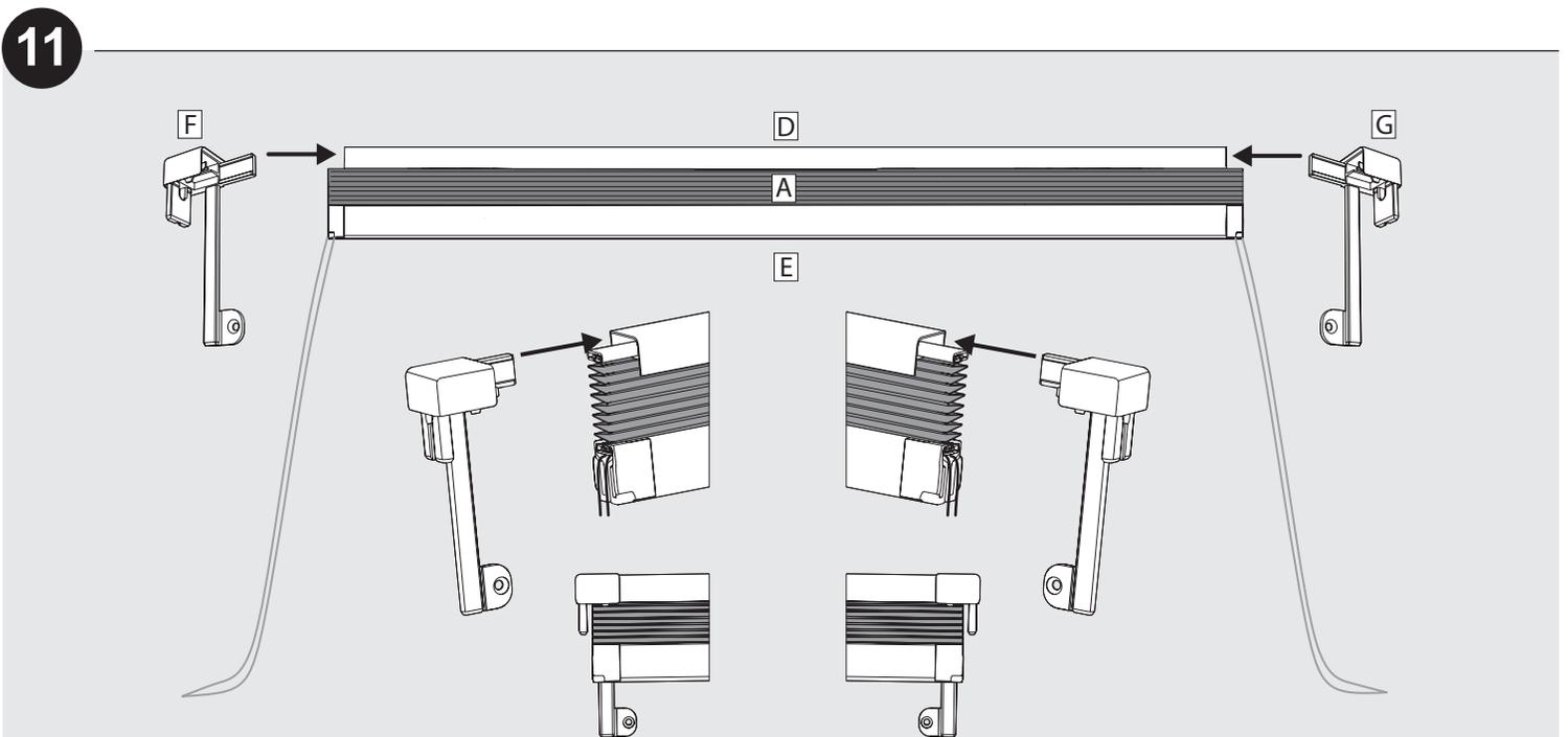
Die Schnur des Insektenschutz-Plissees **A** durch die Eckverbinder **F** und **G** von innen nach außen durchführen. Legen Sie die Schnur so zu recht, dass sich diese beim weiteren Montageverlauf nicht verheddern oder verknoten. Eckverbinder **F** und **G** jeweils links und rechts auf die Plissee-Kassette **D** aufstecken.
