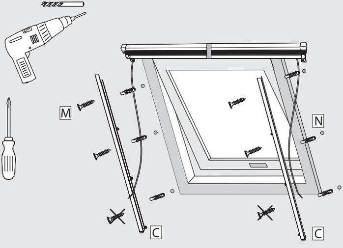
Gekennzeichnete Positionen mit einem Bohrer vorbohren und Dübel **N** einsetzen. Je nach Untergrund ist ein geeigneter Bohrer zu verwenden (nicht im Lieferumfang enthalten). Führungsprofile **C** mit Senkkopfschrauben **M** anschrauben.
