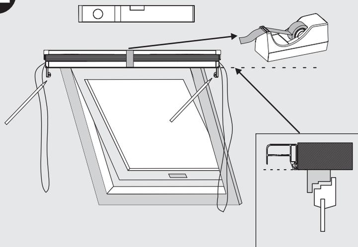
Vormontierte Plisseekassette anhalten. Dabei liegt die hintere, untere Kante der Plisseekassette bündig an der Laibungskante. Mittig und horizontal ausrichten. Bohrlöcher anzeichnen.
