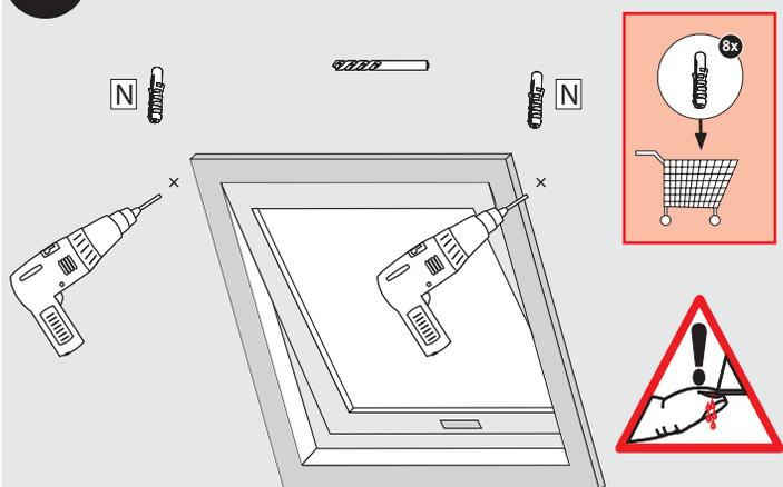
Gekennzeichnete Positionen mit einem Bohrer vorbohren und Dübel **N** einsetzen.
