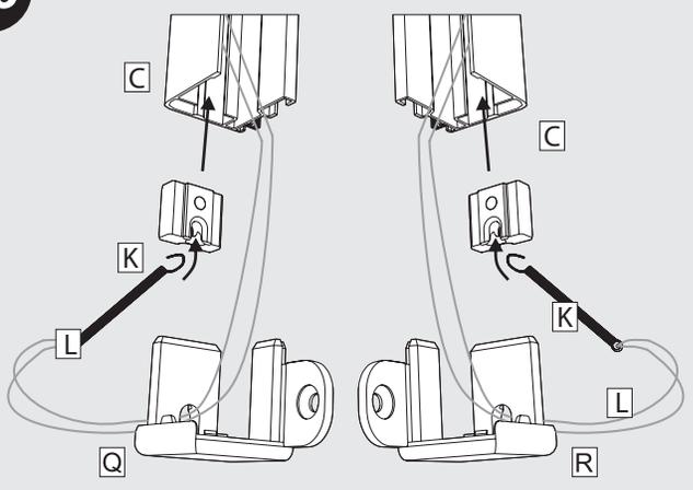
Spannfedern **L** an den Spannleitern **K** einhängen. Spannleiter **K** in die Führungsprofile **C** einsetzen. Endfüße **Q** und **R** auf die Führungsprofile aufstecken.
