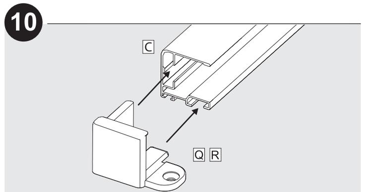
Vorab die beiden Endfüße **Q** und **R** links und rechts auf die beiden Führungsprofile **C** aufstecken.
