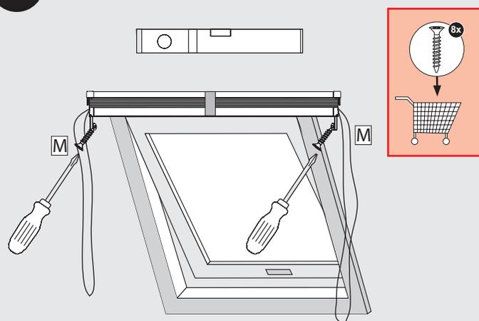
Vormontierte Plisseekassette erneut anhalten und mit Senkkopfschrauben **M** befestigen.
