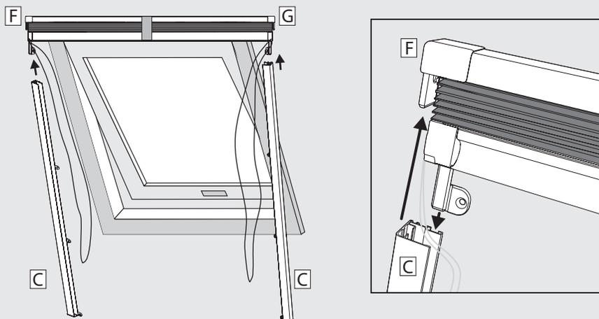
Führungsprofile **C** mit der montierten Plisseekassette verbinden. Dabei Führungsprofile **C** auf die Eckverbinder **F** und **G** aufstecken. Dabei darauf **achten**, dass die Schnur zum Inneren der Führungsprofile verläuft.
