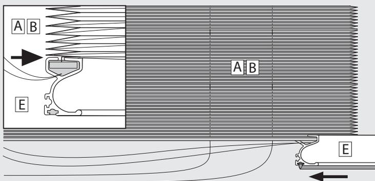
Griffleiste **E** einsetzen. Nehmen Sie zunächst die beiden
