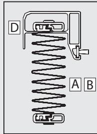
Insektenschutz-Plissee **A** in die Plisseekassette **D** einfädeln.
