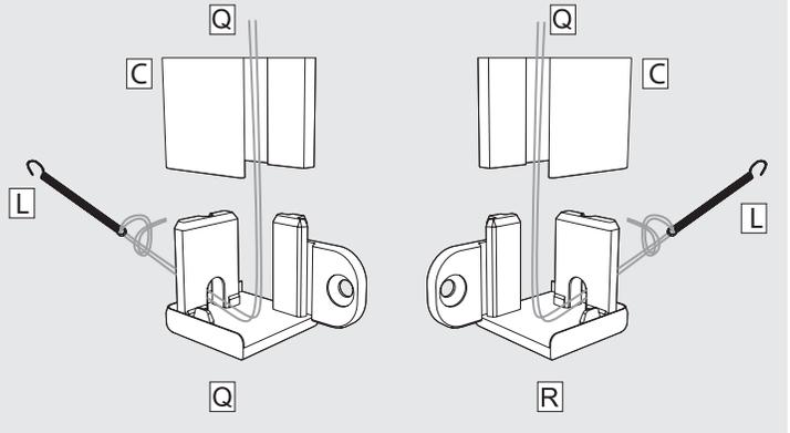
Die Endfüße **Q** und **R** von den Führungsprofilen **C** wieder abziehen. Plisseeschnüre jeweils von innen nach außen (siehe Bild) durch die Endfüße **Q** und **R** fädeln und an den Enden der Spannfedern **L** verknoten.
