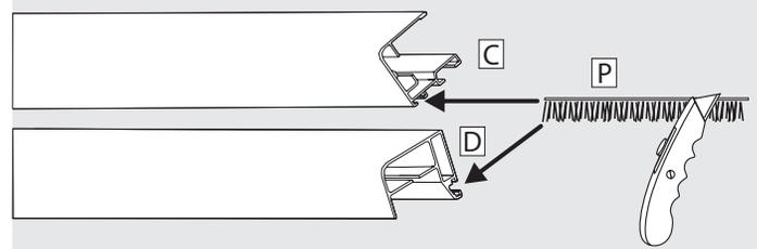
Bürstendichtung **P** in die Führungsprofile **C** und
