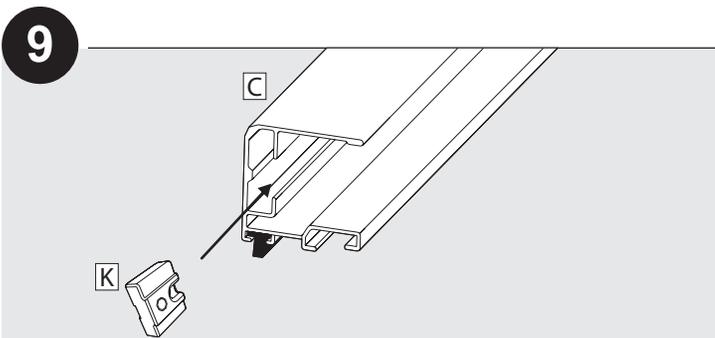
In beide Führungsprofile **C** je 1 Stück Spangleiter **K** (nach außen) zeigend eingesetzt.
