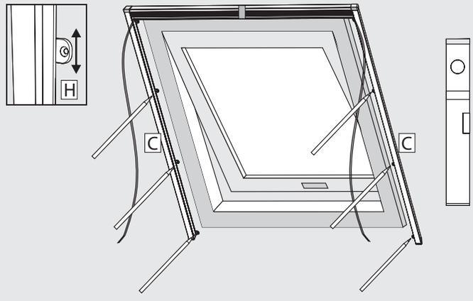
Führungsprofile **C** ausrichten, Wandbefestigungen **H** an die gewünschte Position schieben und Bohrlöcher anzeichnen. Danach die Führungsprofile **C** wieder abnehmen.
